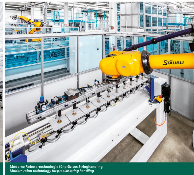
Moderne Robotertechnologie für präzises Stringhandling
