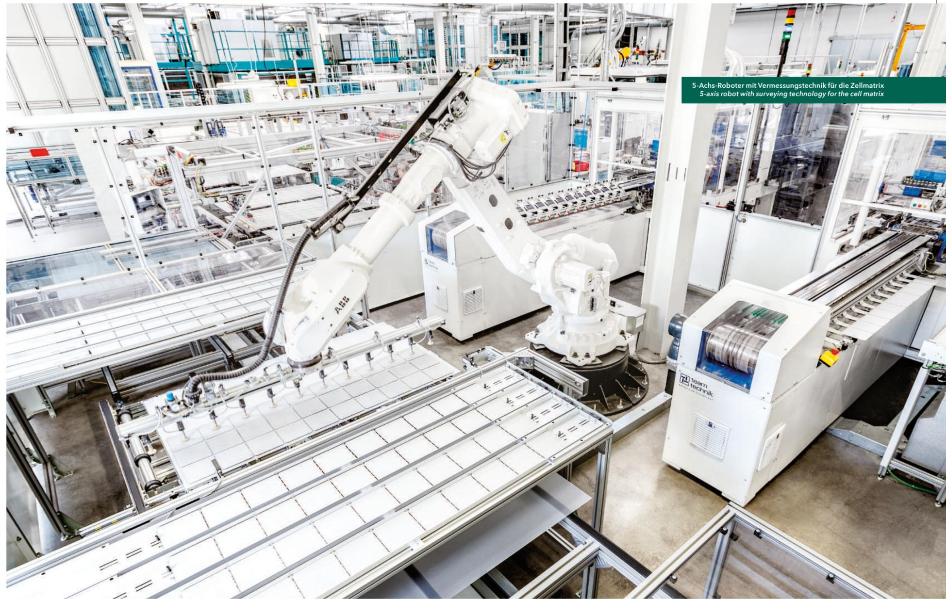
5-Achs-Roboter mit Vermessungstechnik für die Zellmatrix
