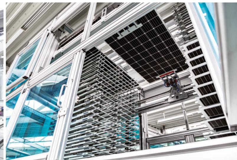
Abkühlurm nach den Laminatoren (Abkühlprozess von 140 auf 25°C)
